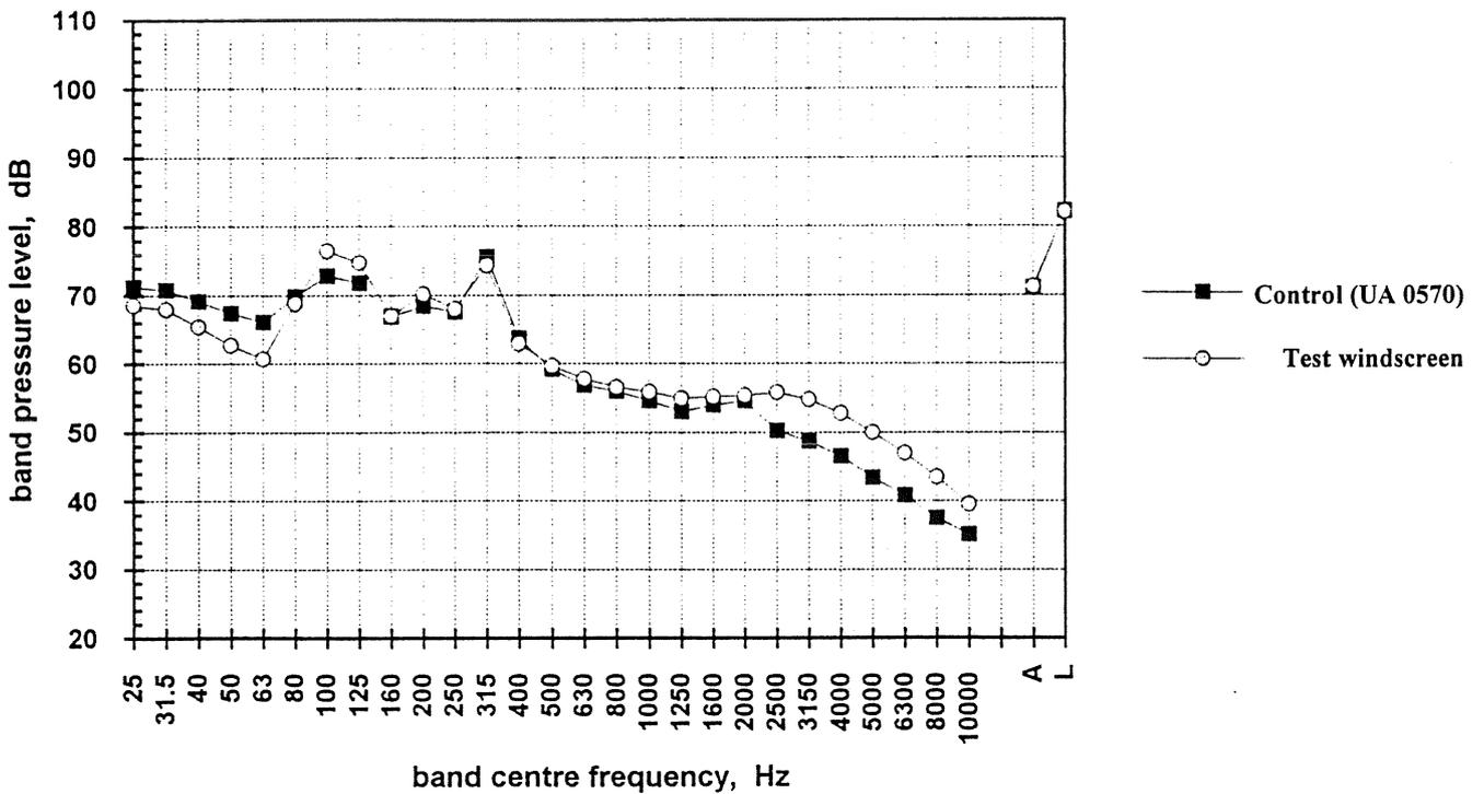
Figure 25 10 ppi hollow windscreen + UA 0237 -v- UA 0570 - smooth flow 10 m/s
