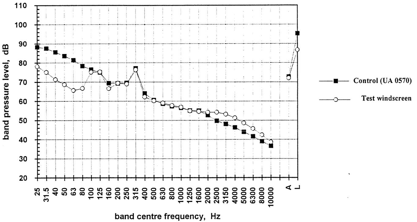
Figure 31 10 ppi hollow windscreen + UA 0237 -v- UA 0570 - turbulent flow
